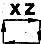
Фрезерование по прямоугольному циклу посредством упоров в плоскости X-Z
