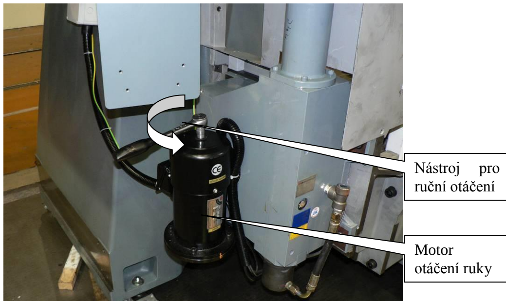
Obrázek 10: Ruční otáčení mechanismu výměny nástroje
