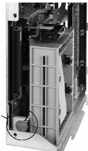
рисунок23 : Резервная батарея
