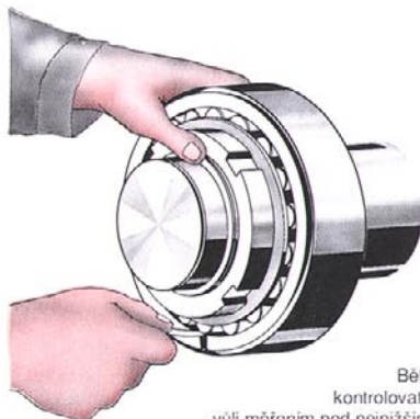
Před montáží soudečkového ložiska s kuželovou dírou změřit spárovými měrkami radiální vůli ložiska.
